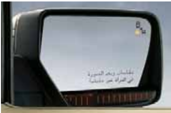
نظام BLIS مع ميزة الإنذار بمرور السيار من الجانبين عند الرجوع
